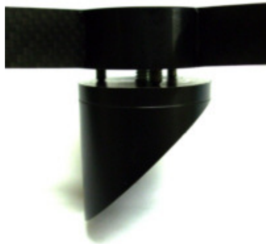
Ronde der Fangspinne mit oben liegender Feder zur exakten Justage ohne Kraft.
